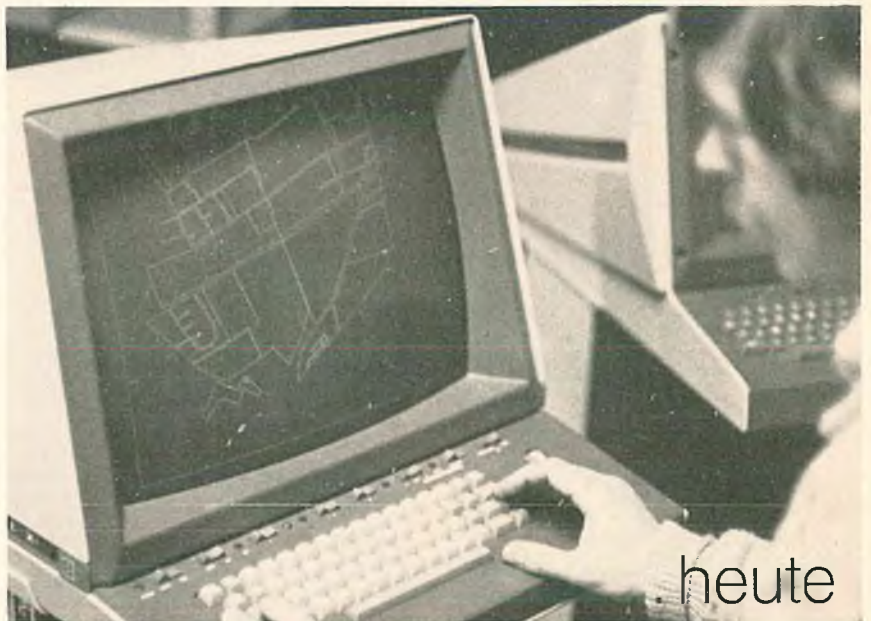
Automatisierte Netzerfassung. Hier: Fehlerkorrektur am Bildschirm
